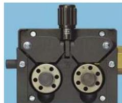
**Starker Drahtantrieb:** souveräner 4-Rollenantrieb mit 50W-Motor und 37mm- Vorschubrollen mit großer Auflagefläche.
