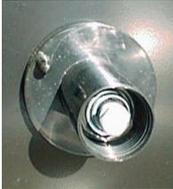
Prüfen Sie die **Funktion der Spulenbremse**, indem Sie die Spule mit der Hand drehen. Bei richtiger Einstellung (Schraube an der Vorderseite des Dorns, siehe Abb.) sollte die Spule nur wenig nachlaufen; es sollte jedoch keine zu hohe Kraft zum Drehen der Spule notwendig sein. Achten Sie außerdem noch darauf, dass das Drahtende unten liegt und die Drähte nicht überkreuzt sind. Schneiden Sie nun das gebogene Ende des Drahtes ab und runden Sie die Spitze mit einer Feile ab.
