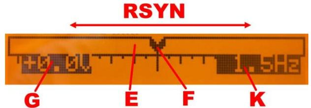
**Beachten Sie:** Wird die Lichtbogenlänge zu kurz eingestellt, können Kurzschlüsse des Drahtendes mit dem Werkstück auftreten. In diesem Fall Lichtbogenlänge etwas in Richtung PLUS (+) stellen. Bereich „K“ wird nur bei Betriebsart MULTI-PULS angezeigt.
