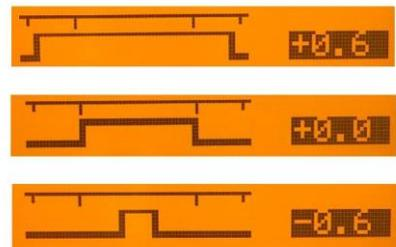
**Beachten Sie:** Sollten kleintropfige Spritzer auftreten, vermindern Sie die Pulsenergie etwas. Treten große Tropfen am Drahtende auf, erhöhen Sie die Pulsenergie etwas. Sollte der Lichtbogen im unteren Energiebereich abreißen, erhöhen Sie die Pulsenergie leicht.
